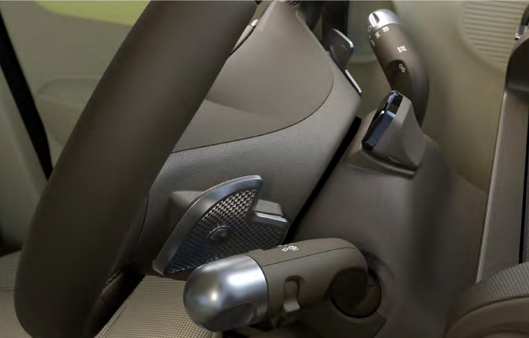
O Sistema de Travagem Regenerativa do INSTER carrega a bateria enquanto conduzes, utilizando o motor elétrico para abrandar o veículo. É possível controlar o nível de energia que o sistema regenera e armazena na bateria, ajustando o nível de travagem regenerativa com as patilhas montadas no volante.
